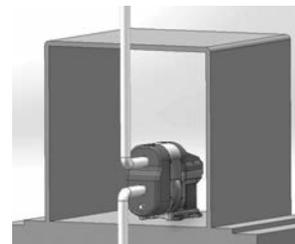
Насос должен быть установлен в удобном для его осмотра и обслуживания, сухом и проветриваемом месте.
