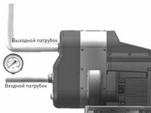
Перед поворотом выпускная труба должна быть на 600 мм выше входной, а длина входной трубы не должна превышать максимальный диапазон всасывания насоса.
